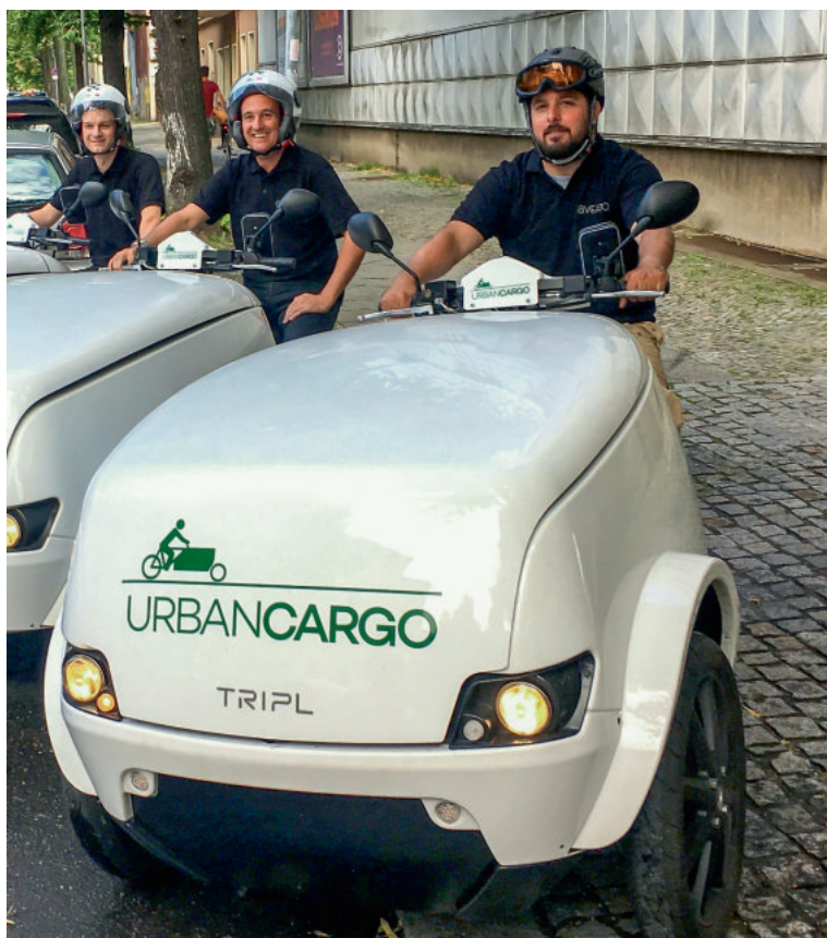
Schick, wendig, praktisch: der Tripl E-Cargo Scooter, ein deutsch-dänisches Gemeinschaftsprojekt. Je nach Batterietyp packt er bis zu 100 Kilogramm pro Ladezyklus und buckelt locker 200 Kilogramm.
